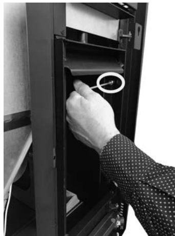
Fig. 67 - Αφαιρέστε τη βίδα 2
