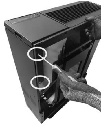
Fig. 29 - Στερέωση επάνω βραχίονα
