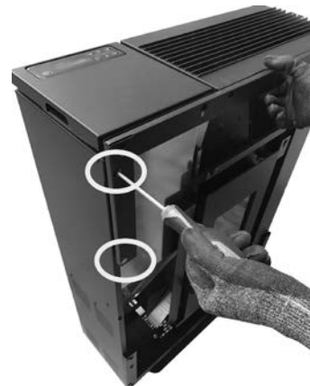
Fig. 36 - Στερέωση επάνω βραχίονα
