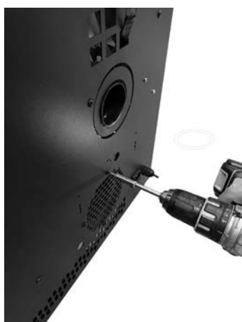
Fig. 70 - Αφαιρέστε τις βίδες
