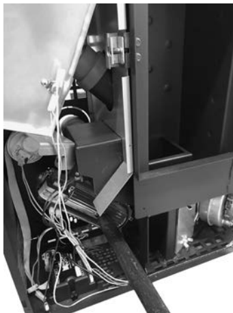
Fig. 69 - Καθαρισμός ανεμιστήρα περιβάλλοντος
