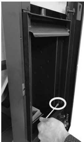
Fig. 66 - Αφαιρέστε τη βίδα 1
